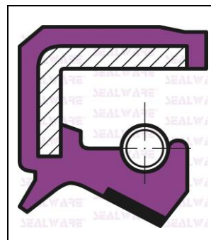
Bauform AST gummiert und reibungsreduziert mit zusätzlicher Staublippe
