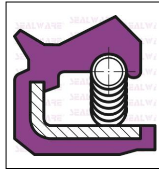
Bauform ASJ, außendichtend mit zusätzlicher Staublippe
